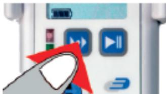
Ao pressionar o botão de modo, as respectivas medições de média (AVG), mínima (MIN) e máxima (MAX) de cada canal de medição serão exibidas.
