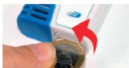
Para substituir a bateria, abra a tampa da bateria na parte traseira. Portanto, você precisa girar a tampa da bateria 20 ° para a esquerda. Use uma moeda para abrir / fechar a tampa da bateria.
